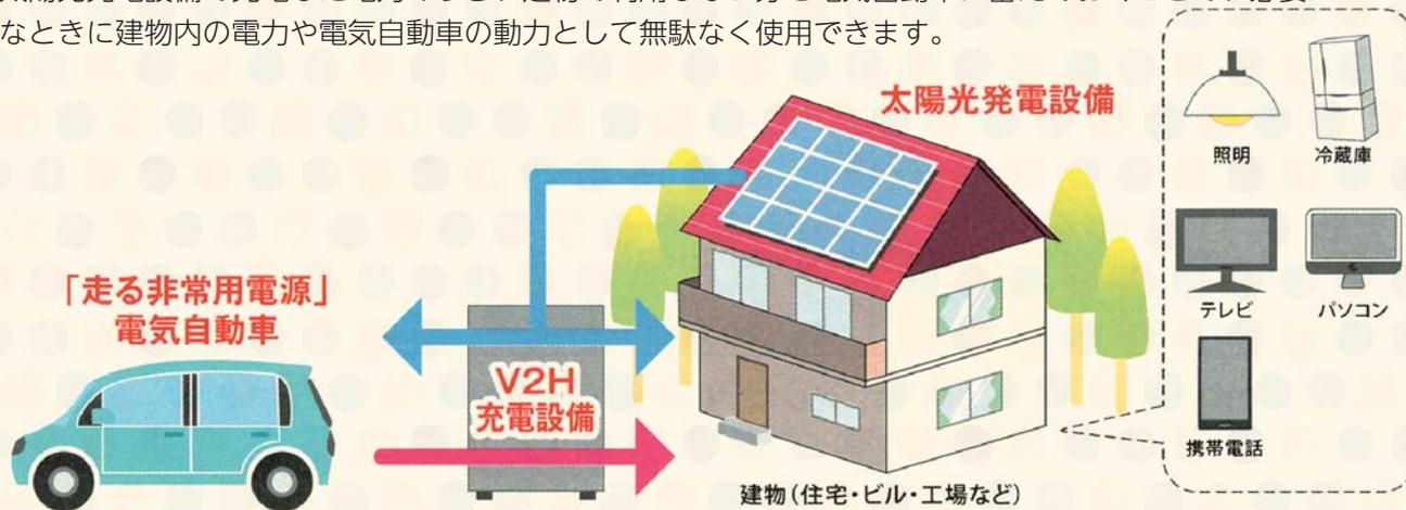
V2H(ヴィークル・トゥ・ホーム) は電気自動車などに搭載された電池から家庭に電力を供給できる仕組みです。電気自動車の電池を非常用電源として活用したり、電気自動車に貯められた電気を上手く利用して電気代を節約することができます。
